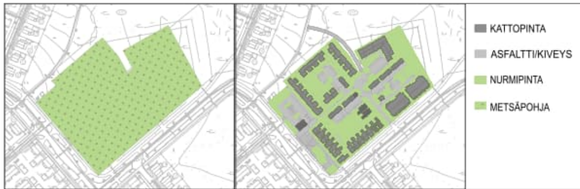
kuva 8. Hulevesilaskennassa käytettyjen pintojen sijoittuminen selvitysalueella ennen rakentamista (vas. ruutu) sekä rakentamisen jälkeen (oik. ruutu). Perustuu viitese suunnitelmaluonnokseen (kuva 7).
